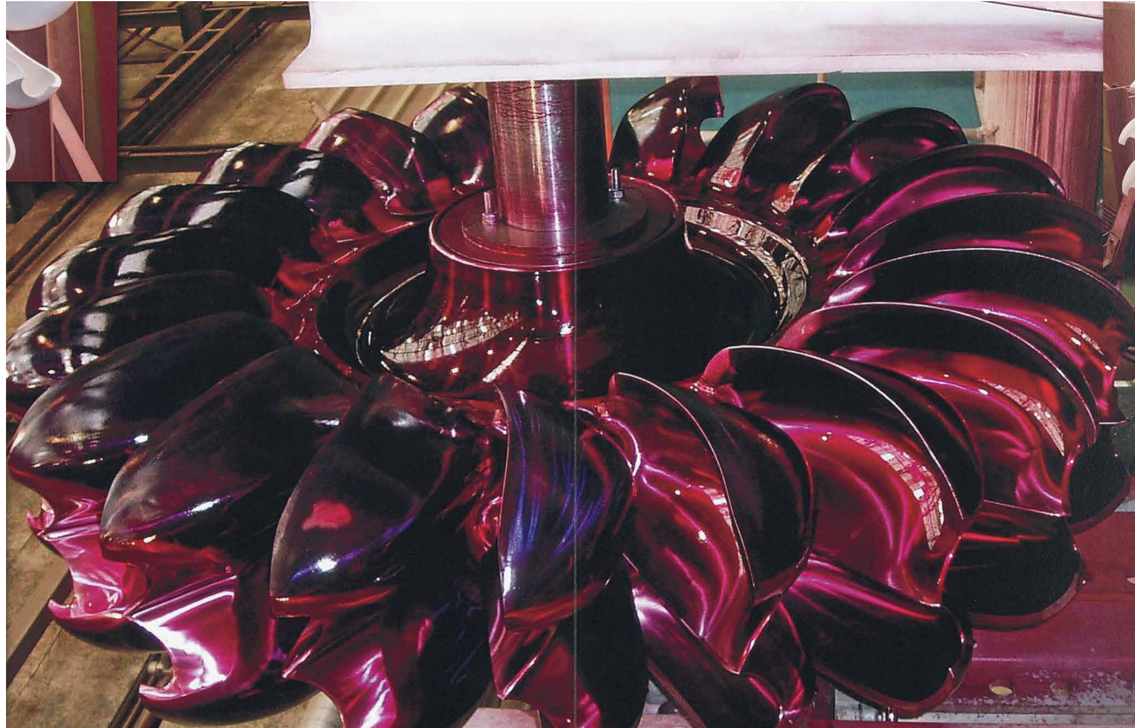
Abnahme Laufrad Maschine 1, 2006 (Foto: Wasserkraftwerk Stechelberg)
